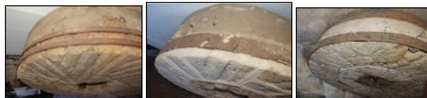
Zunchos sujetan los trozos de piedras
